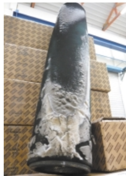
Zanesený filtrační element
